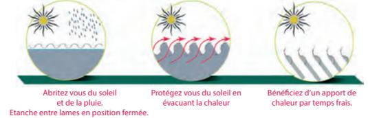
Rotation des lames manivelle magnétique de 0 à 120°
