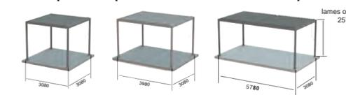
(épaisseur des poteaux : 4mm / lame double paroi 2 joints)
